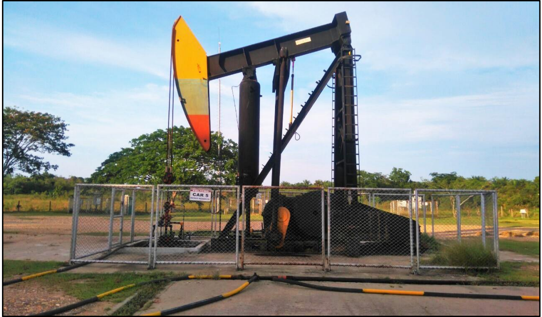
Figura 17. Unidad balanceada por aire, Bombeo Mecánico.
