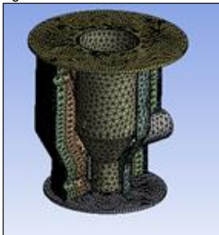
Figura 28. Enmallado del reactor
