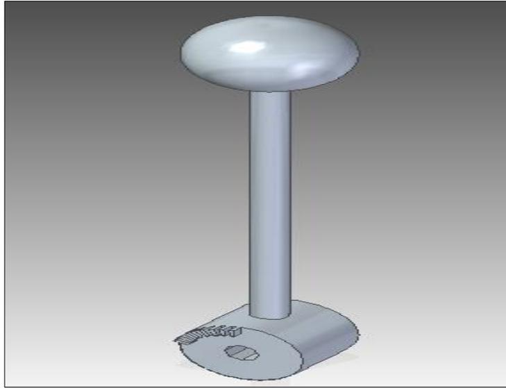
La longitud de la palanca es una variable dependiente de la fuerza necesaria para accionar el embrague y el freno, para esto se debe tener en cuenta el funcionamiento de todo el sistema de accionamiento completo.
