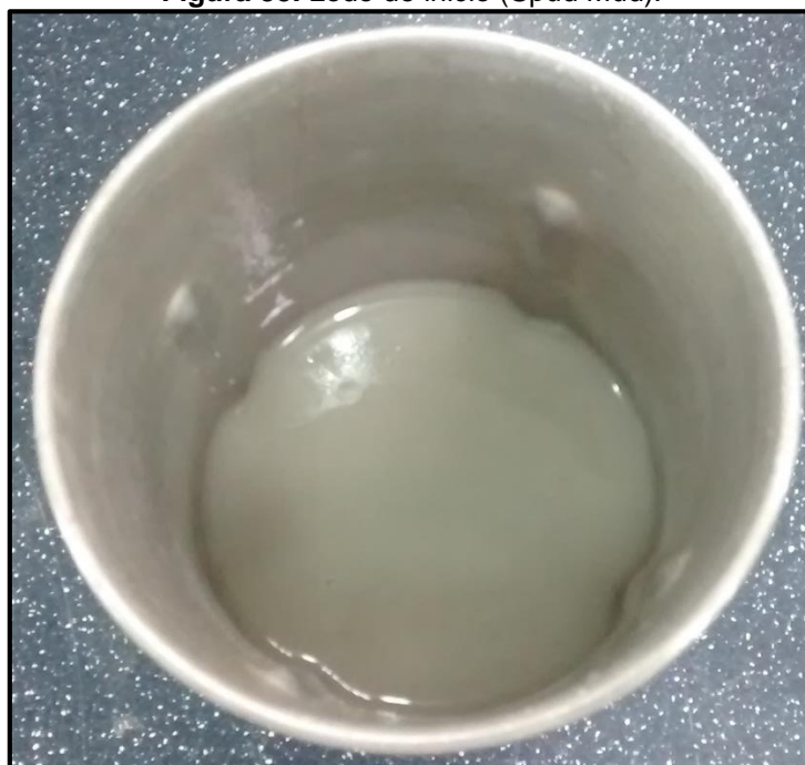
Figura 35. Lodo de inicio (Spud Mud).
