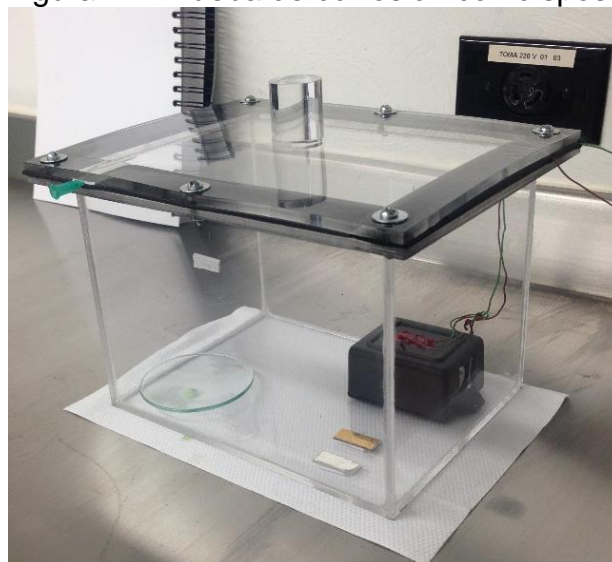
Figura 12. Prueba de corrosión con dispositivo fotocatalítico.
