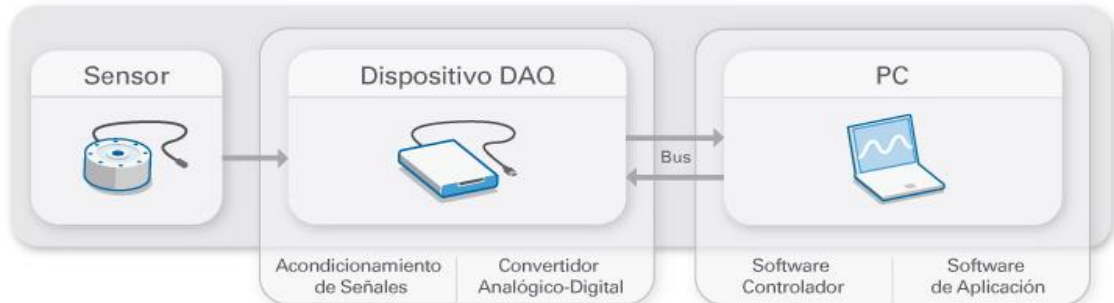
Figura 2. Partes de un sistema DAQ.
