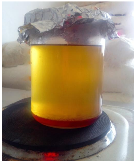
Imagen 2. Obtención de biodiesel y glicerina
