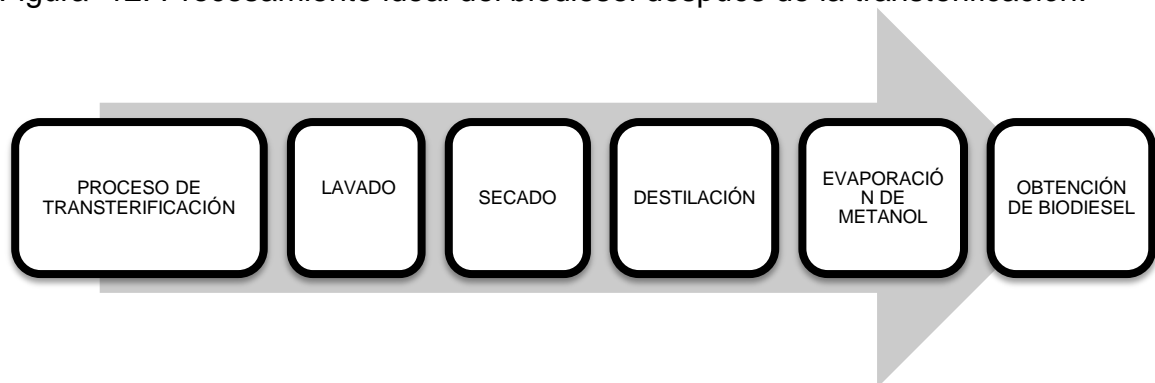
Figura 12. Procesamiento ideal del biodiesel después de la transterificación.
