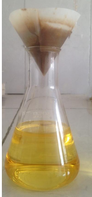
Imagen 5. Filtración por gravedad con Tierras Diatomeas
