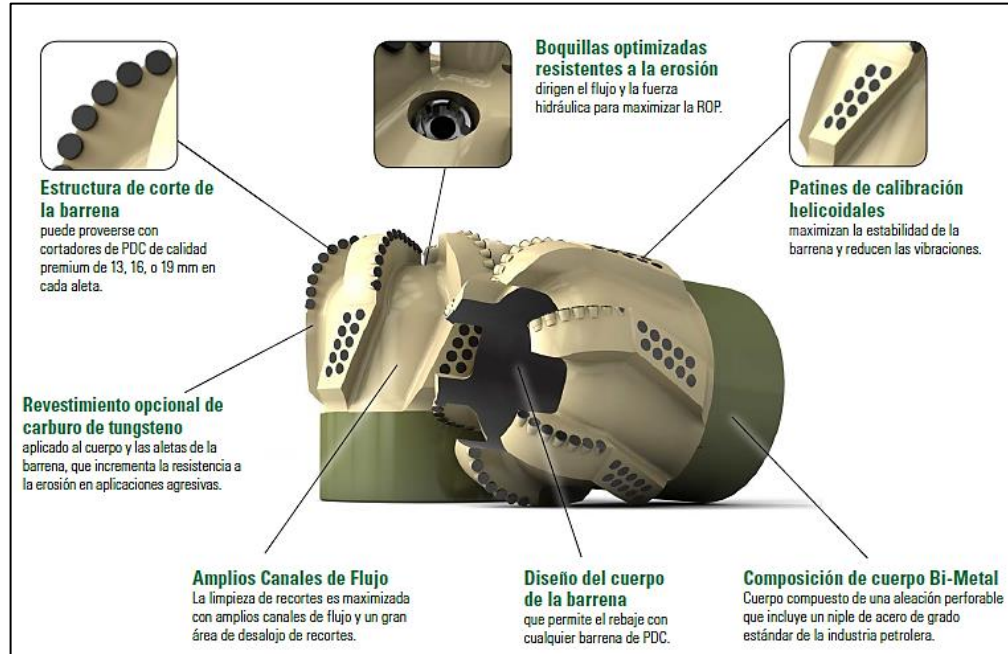
Figura 10. Características básicas de una broca perforable
