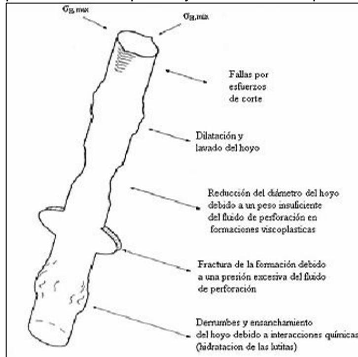
Figura 36. Problemas operacionales ocasionados por inestabilidad química y mecánica de un pozo.
