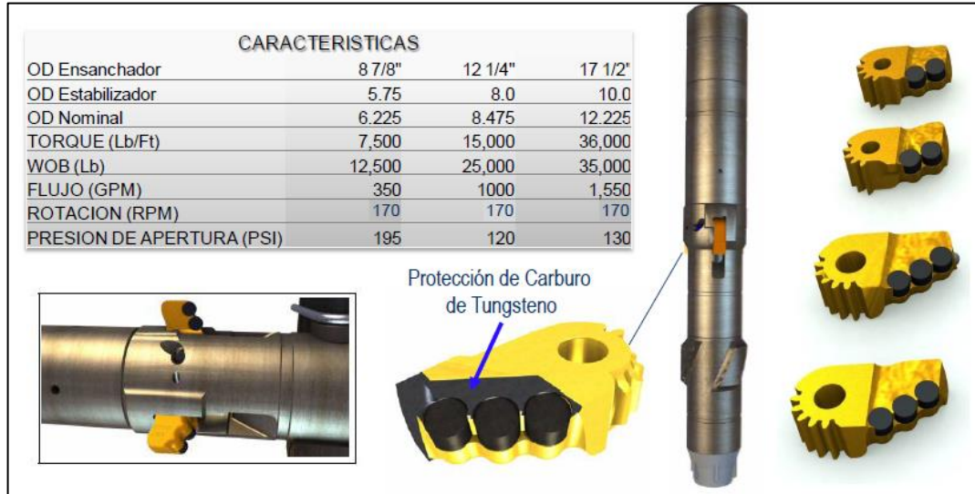
Figura 23. Características de los ensanchadores
