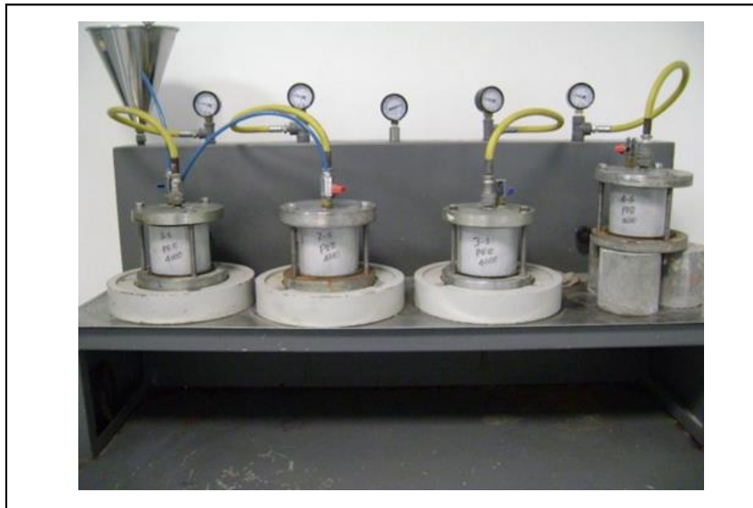
Figura 21. Ensayo permeabilidad del concreto al agua
