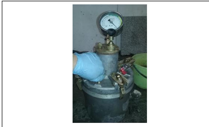
Figura 11. Prueba de contenido de aire.
