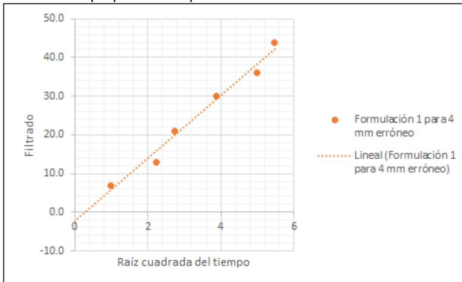
**Gráfica 8.** Prueba PPT para píldora de fibra soluble en ácido para preparación 1.
