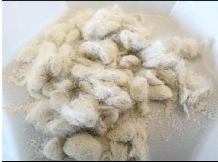
El objetivo de la píldora de sello por alta filtración, es el de debe formar una capa sintética o tapón sintético de alta resistencia, que se asemeja bastante a varias capas de tela (**Figura 26**), sobre la formación donde se encuentra la pérdida de circulación. Este material no es soluble 100% en ácido clorhídrico (HCl), ya que la fibra celulosa no es soluble en ácido y no es posible su remoción. Sus principales propiedades físicas son:
