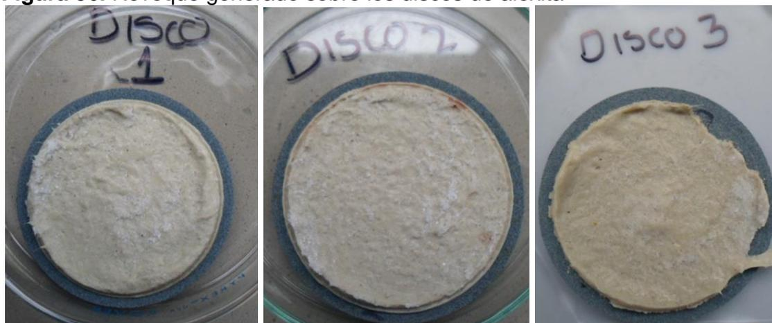
**Figura 37.** Discos de aloxita sumergidos en HCL
