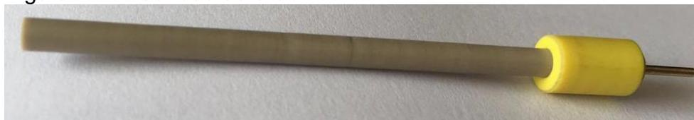
**3.4.3 Electrodo de referencia.** La finalidad del electrodo de referencia es proporcionar un voltaje estable a la solución. Para este caso se seleccionó un electrodo de alambre de plata de marca BASi serial MW-1085, mostrado en la figura 22.
