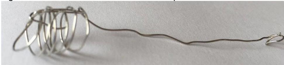
**3.4.5 Limpieza del electrodo de trabajo.** Por cada medición que se realiza en ambos métodos de seguimiento electroquímico se debe realizar una limpieza al electrodo, en este caso es necesario pulir el área del electrodo (parte inferior) con una lija de tamaño de grano de 1 micrómetro y 0,05 micrómetros, con el fin de eliminar los productos de la reacción redox que se acumulan durante la medición.
