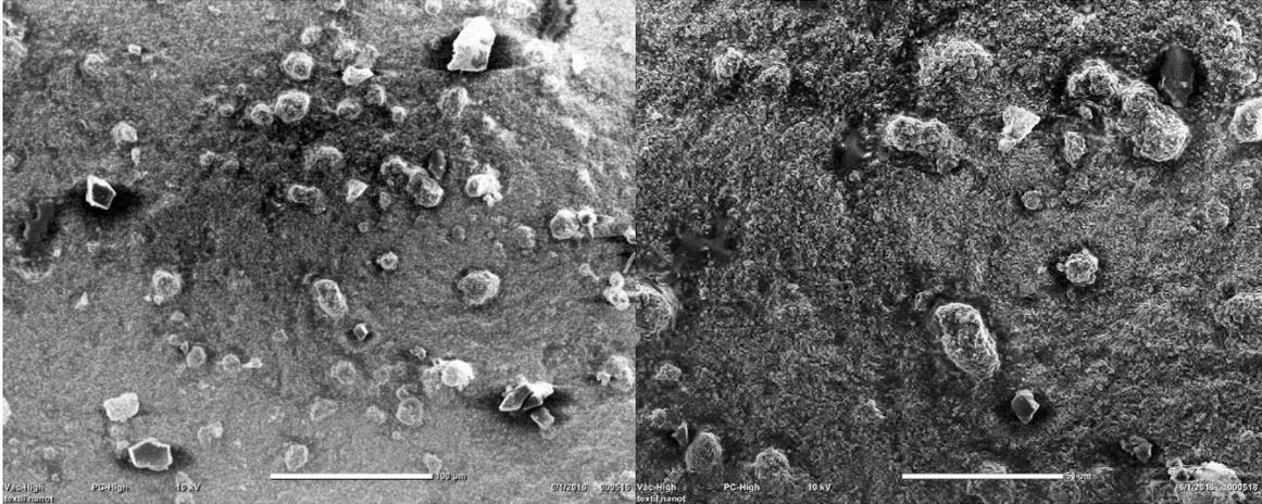
Figura 14. Microscopia Electronica de barrido para el  $\text{TiO}_2$
