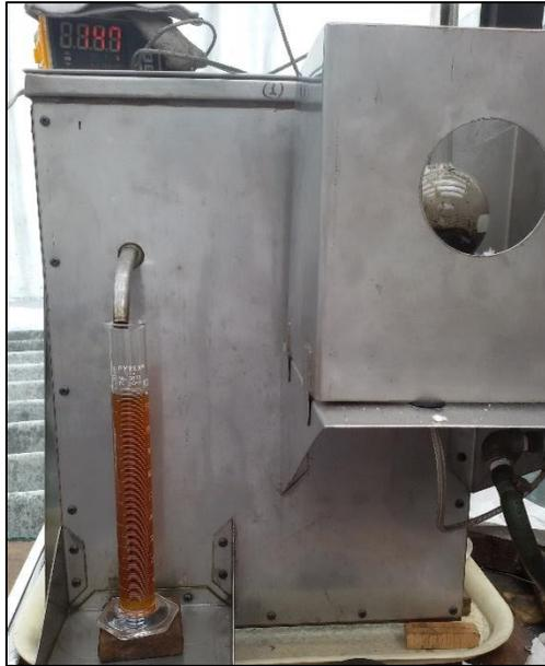
Este método de ensayo cubre la destilación atmosférica de los productos de petróleo utilizando una unidad de destilación de laboratorio (ver **anexo 9**) para determinar cuantitativamente las características de rango de ebullición de productos tales como: gasolinas naturales, destiladas medias y livianas, combustibles diésel con contenido de azufre regular, queroseno y fuel oíl grado 1 y grado 2.<sup>79</sup>
