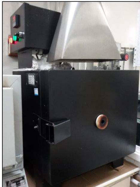
Prueba de cenizas para el Diesel
