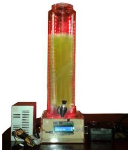
Figura 4. Fotobiorreactor Air-lift a escala laboratorio
