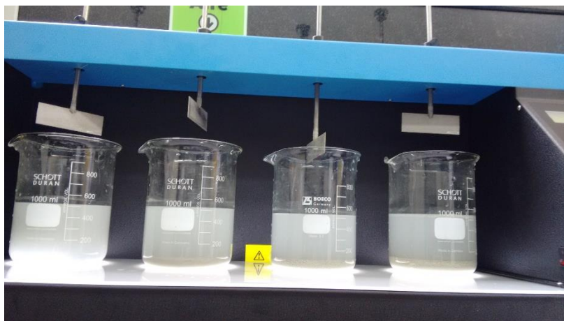
Figura 8. Ensayos del sulfato de aluminio a diferentes concentraciones.
