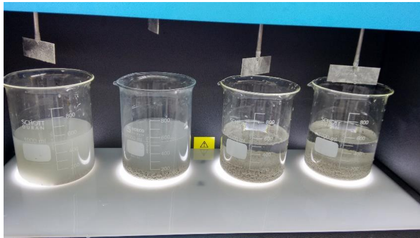
Figura 9. Ensayos del policloruro de aluminio a diferentes concentraciones.
