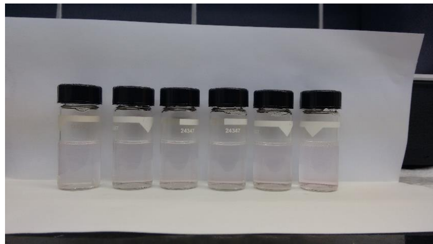
Figura 13. Muestras con cloro añadido entre 70 y 120 ppm.
