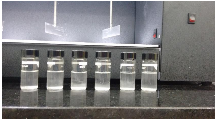
Figura 12. Muestras con cloro añadido entre 10 y 60 ppm.
