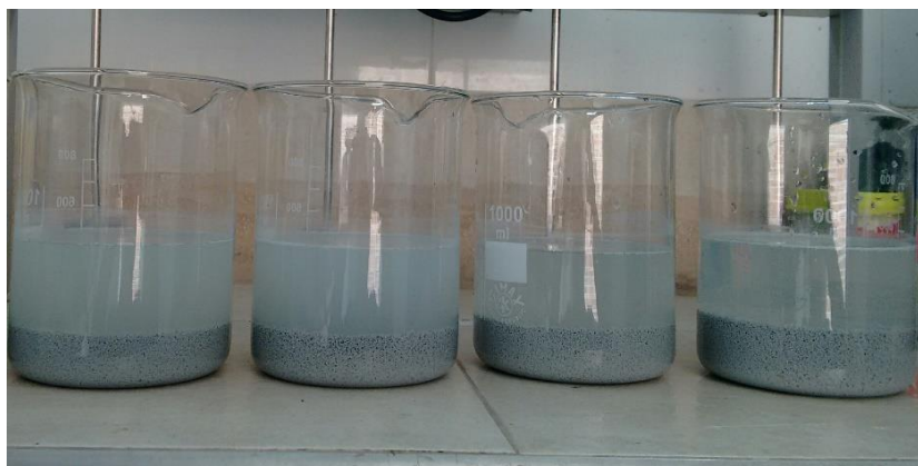
Figura 11. Dosis óptima de floculante.
