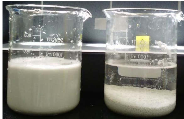
Figura 14. Antes y después del proceso de clarificación.
