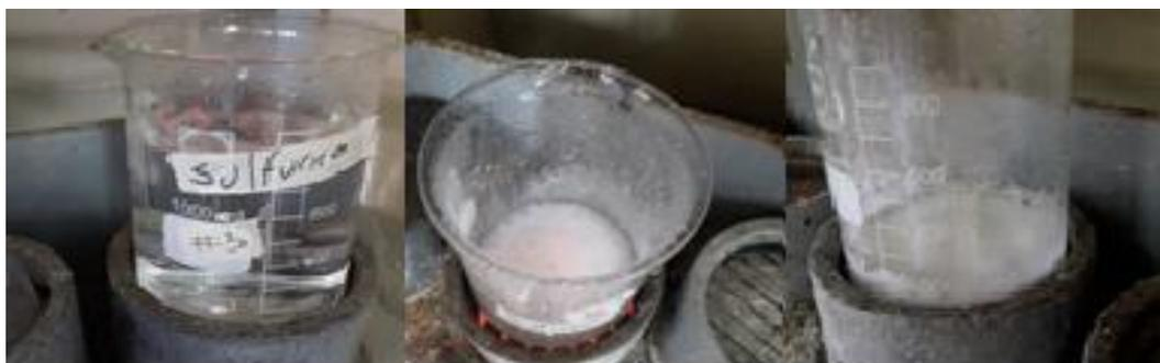
**2.9.3 Filtrado.** Obtenidos los cristales, es necesario separarlos de la fase líquida por medio de la filtración. En ella se observó que los cristales obtenidos todavía cuentan con un alto grado de humedad, lo que hace necesario el proceso de secado.
