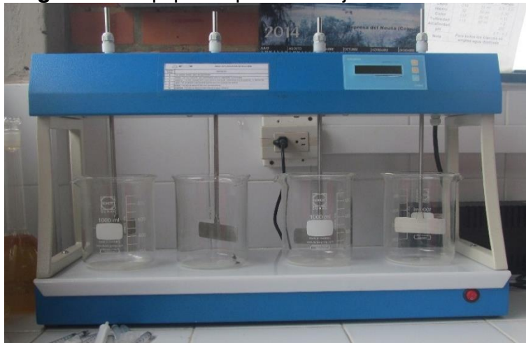
Figura 22. Equipo de prueba de jarras automática.
