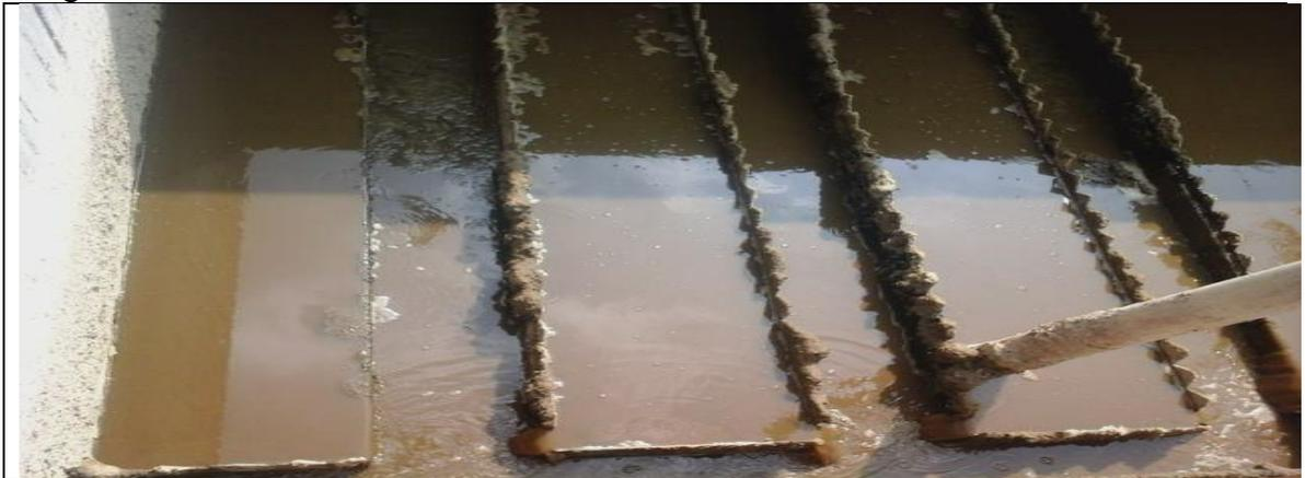
**ESPESADOR DE LODOS:** Se encarga de retirar la mayor cantidad de agua de los lodos y traslado al tanque recolector de lodos del DAF para luego ser deshidratados en el D-Canter.
