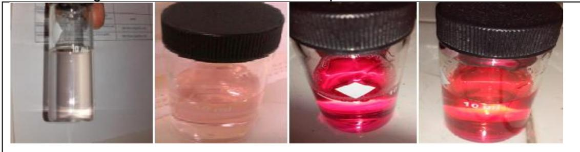
En la imagen 21 se observa los diferentes tonos de rosa que se obtiene al realizar las pruebas de cloro en donde el rosa intenso de la tercera y cuarta imagen representa la alta concentración de cloro residual y el rosa claro de la primera y segunda imagen representan menor concentración de cloro residual, esta coloración está directamente relacionada con la materia orgánica oxidada en cada una de las muestras.
