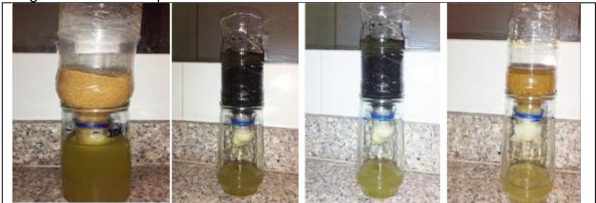
En la imagen 18 se muestra los filtros realizados para el procedimiento mencionado anteriormente, con el fin de definir la altura de cada lecho filtrante se simula un filtro a pequeña escala con botellas pet y un tapón de algodón para cada alternativa
