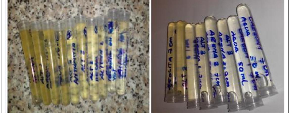
En la imagen 20 se presenta los diferentes cambio de color después de realizar todo el proceso de filtrado para cada alternativa mientras se varia la altura de cada lecho filtrante (Alternativa 2 imagen de la izquierda. Alternativa 3 imagen de la derecha)
