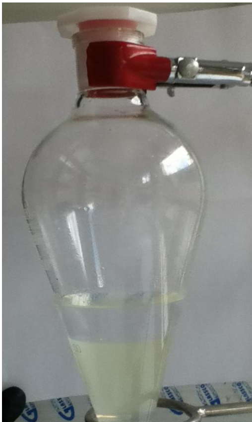
Imagen 8. Extracción líquido-líquido en embudos de decantación
