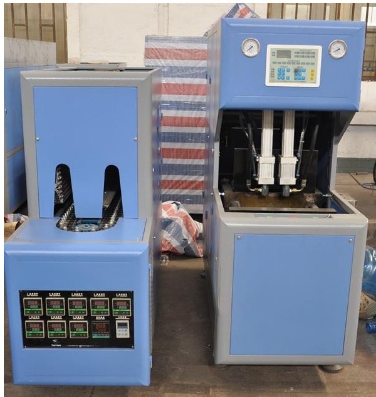
Imagen 7. Sopladora semiautomática modelo VMKY-8Y
