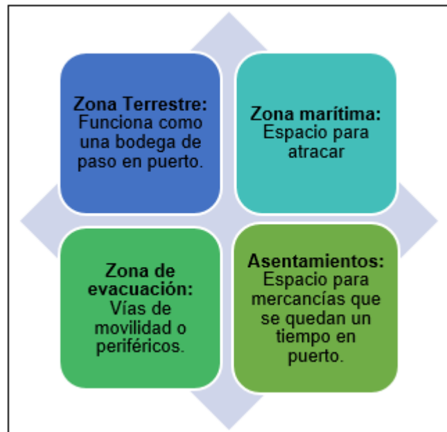
Figura 14. Sectorización del puerto.
