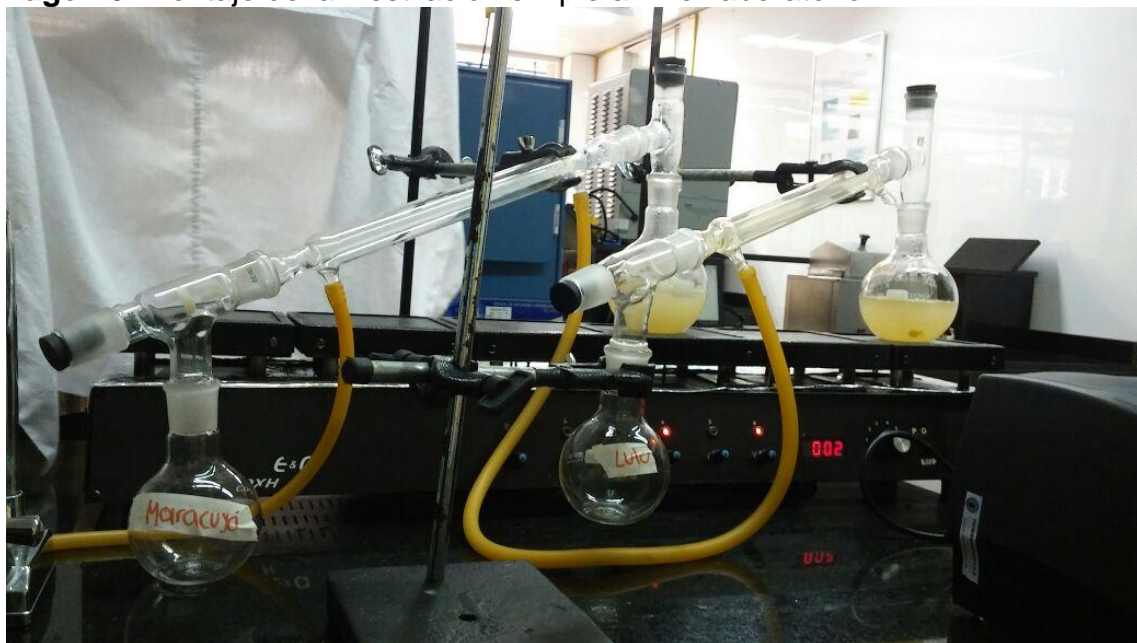
Imagen 6. Montaje de la Destilación simple a nivel laboratorio.
