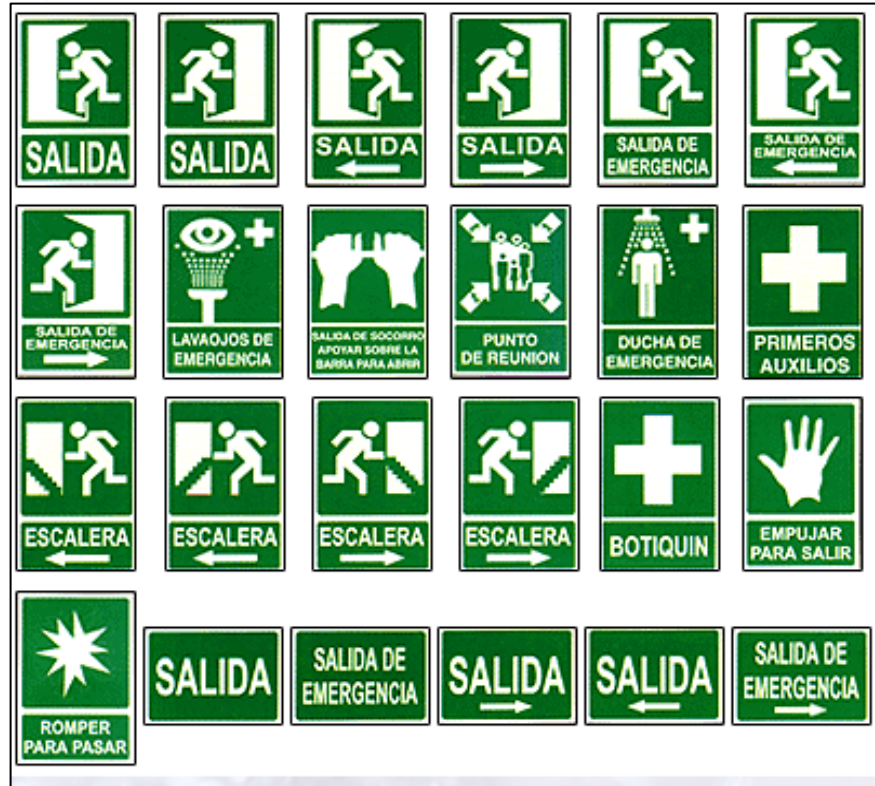
Figura 111. Señales de evacuación.
