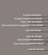
losa en concreto h=0.15
