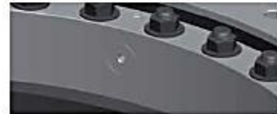
Soft spot del tapón / Filling plug's soft spot
