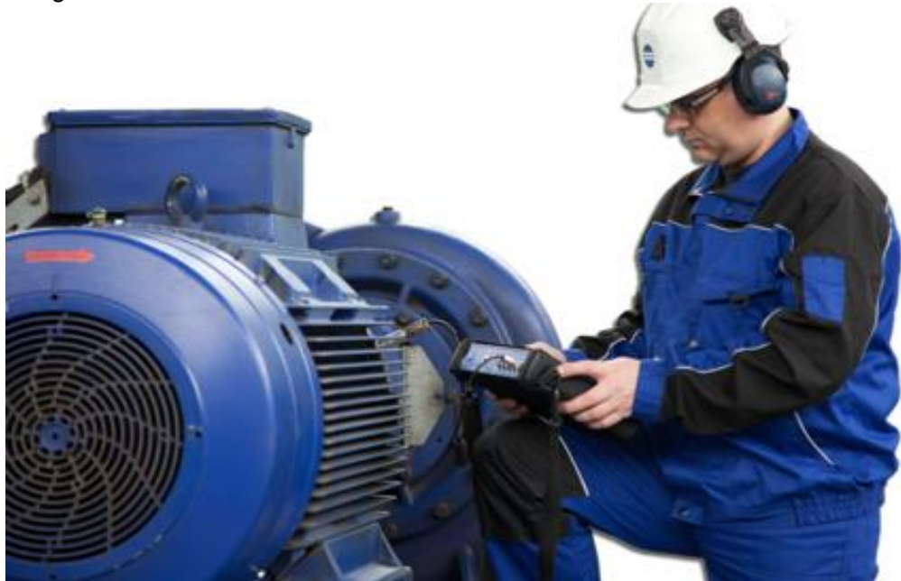
Imagen 125. Análisis de vibraciones
