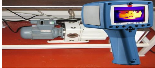
Imagen 121. Inspección cámara termografía
