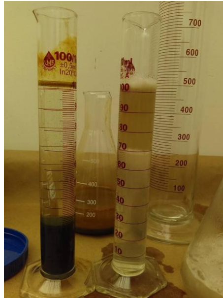
Fotografía 3.Sedimentación y floculación del lodo
