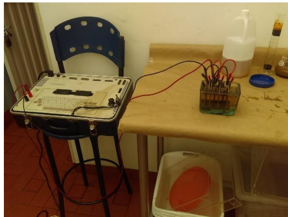
Fotografía 1. Montaje de electrocoagulación
