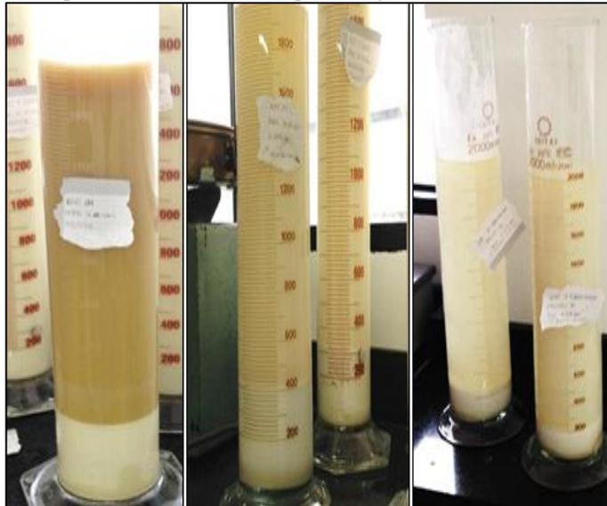
El primer decantado dura en promedio  $\pm 22$  horas, el segundo decantado se estableció un tiempo de 70 horas, ya que después de transcurrido este tiempo el ataque bacteriano es evidente, a diferencia de los procesos de extracción de almidón de diferentes alimentos utilizados en la industria, que oscilan entre 48 y 72 horas.<sup>28</sup>
