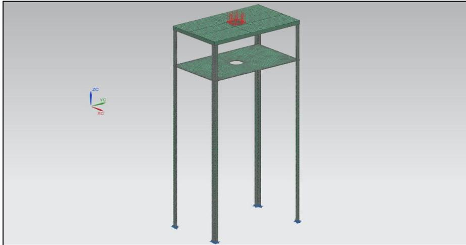
5.3.2 Simulación del desplazamiento nodal. Se observan los resultados de los desplazamientos en los elementos más críticos de la estructura del motor. (Los resultados se encuentran en mm).
