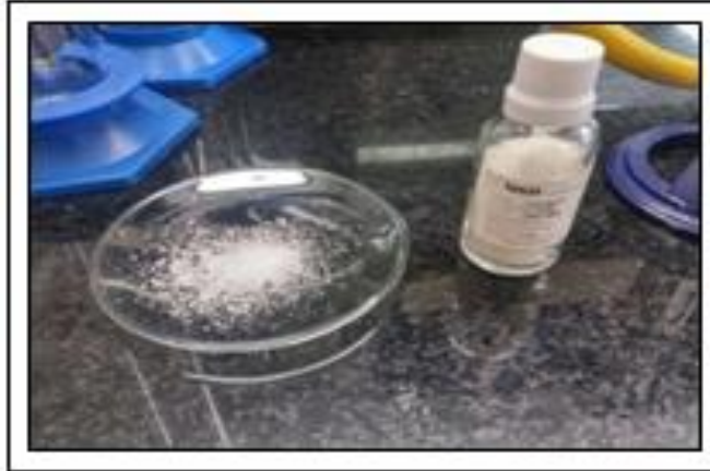
Figura 30. Cantidad de floculante 1538 pesado para la preparación.
