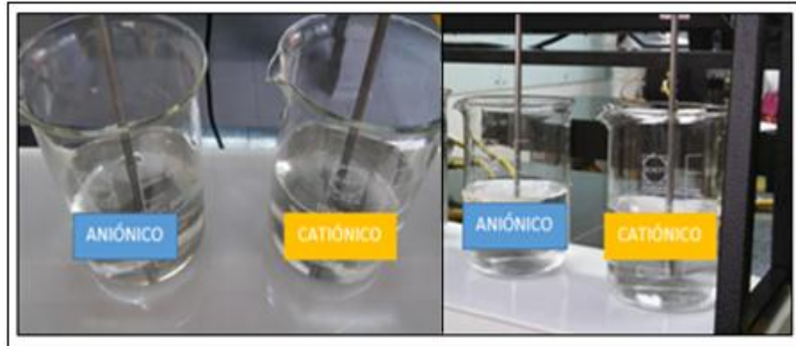
Figura 31. Preparación del floculante.
