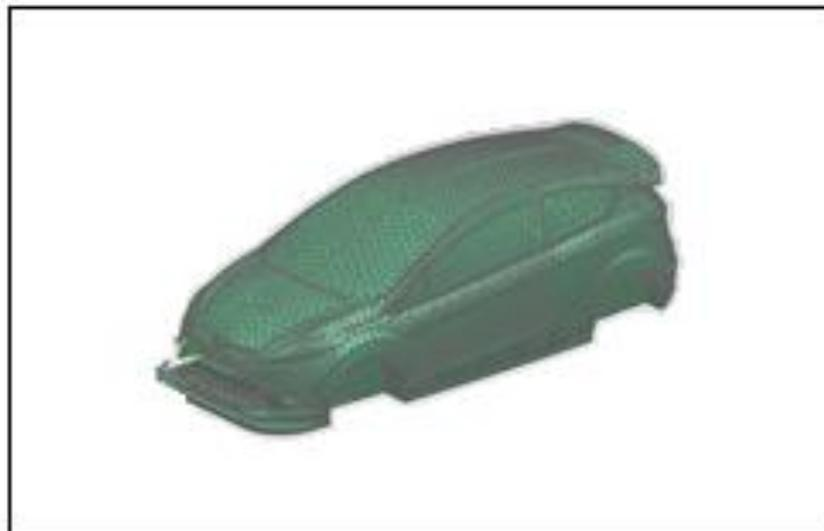
En la figura 31 se muestra el control de malla es usado para generar los puntos de estudio sobre el modelo CAD Ford Fiesta con el fin de que el programa genere resultados de fuerza de arrastre y de sustentación en el centroide del modelo CAD Ford Fiesta.
