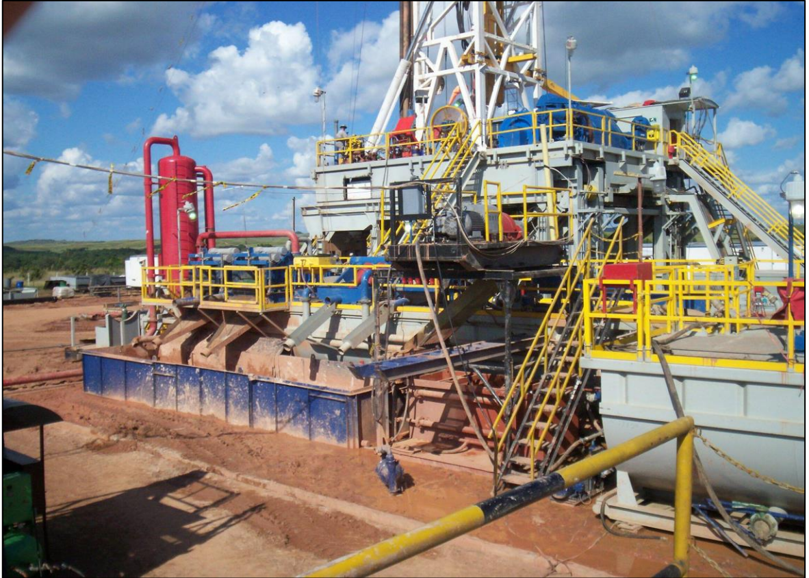
Gráfica 2. Sistema de control de sólidos de un taladro
