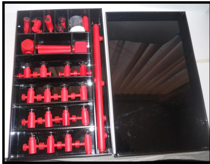
Imagen 6. Choke Manifold desarmado.
