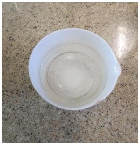
**2.4.2 Sólidos volátiles (SV).** Se empleó la cápsula con el peso final de los sólidos totales y se llevó a una mufla a una temperatura de 500-550°C por 10 minutos, se dejó enfriar y se leyó el peso final. Los datos obtenidos se reportan en mg/L. En la figura 14 se muestra la cápsula empleada para este parámetro.
