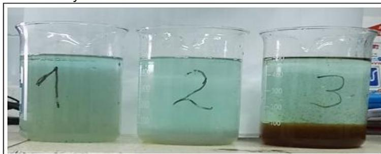
Posteriormente se deja sedimentar las muestras y se procede a hacer la medición de pH, hacer el cálculo de las concentraciones de producto en mg/L y así elegir la mejor muestra para ser llevada al laboratorio y realizar análisis de otros parámetros (cloro libre, color, turbidez, hierro, DQO y solidos suspendidos). Ver **Tabla 4**.
