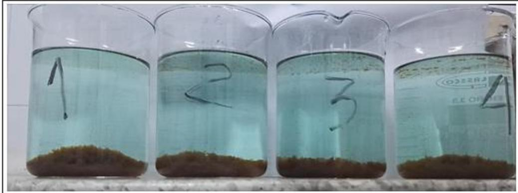
En el último ensayo se pone a prueba a diferentes dosificaciones los productos usados anteriormente variando la dosificación del floculante (L1521) y además se evalúan los filtros de arena y de carbón activado. Ver **Cuadro 5** y **Figura 21**.
