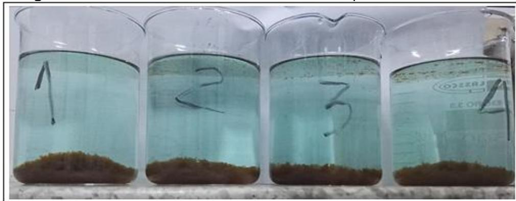
Posteriormente se deja sedimentar las muestras y se procede a hacer la medición de pH, hacer el cálculo de las concentraciones de producto en mg/L y así elegir la mejor muestra para ser llevada al laboratorio y realizar análisis de otros parámetros (cloro libre, color, turbidez, hierro, DQO y solidos suspendidos) Teniendo en cuenta que se varia las concentraciones de floculante 1521. Ver **Tabla 8**.
