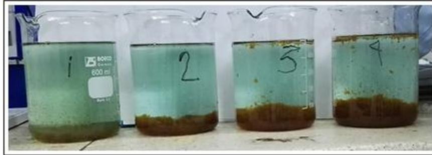
Posteriormente se deja sedimentar las muestras y se procede a hacer la medición de pH, hacer el cálculo de las concentraciones de producto en mg/L y así elegir la mejor muestra para ser llevada al laboratorio y realizar análisis de otros parámetros (cloro libre, color, turbidez, hierro, DQO y solidos suspendidos) Teniendo en cuenta que se varia las concentraciones de coagulante cloruro férrico. Ver **Tabla 6**.
