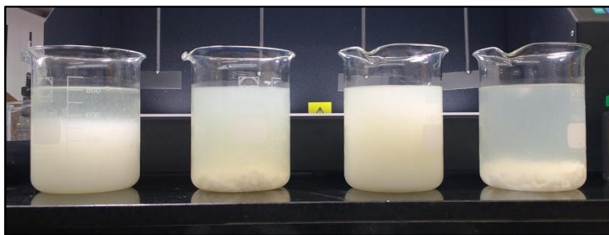
Figura 14. Ensayo de jarras 1 para determinación de polímero floculante.
