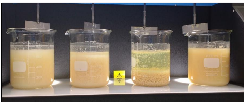
Figura 15. Ensayo de jarras 2 para evaluación de Cloruro férrico.
