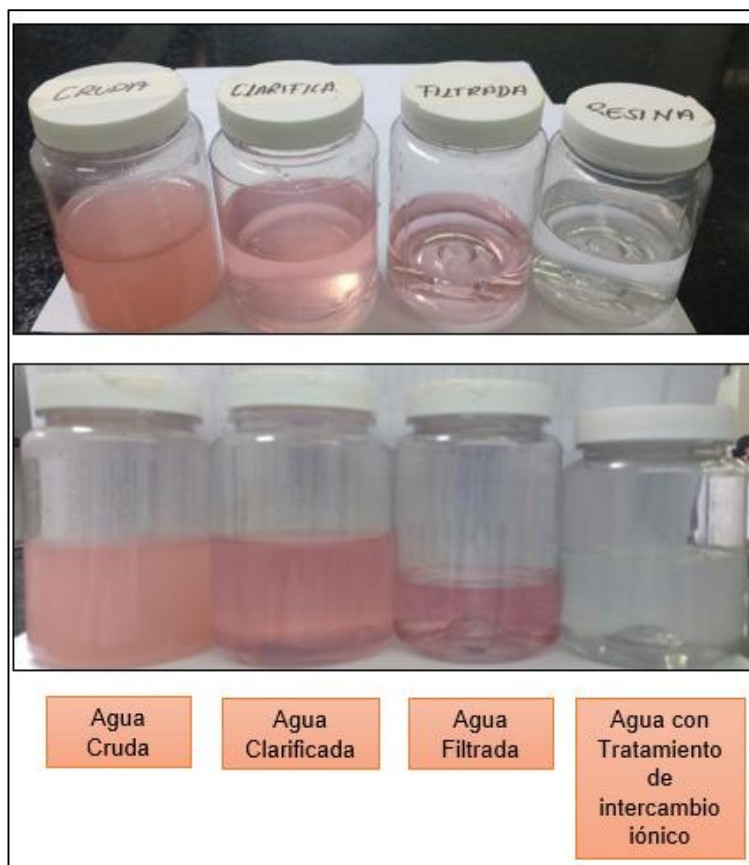
Figura 25. Comparación de agua cruda, clarificada, filtrada y con aplicación de intercambio iónico.
