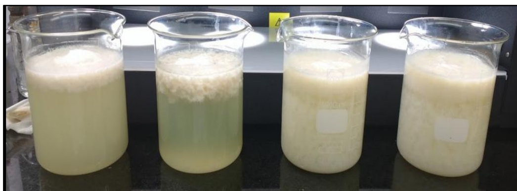
Figura 17. Ensayo de jarras 4 para evaluación de Sulfato de aluminio.
