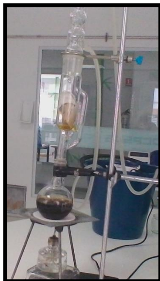
Ilustración 8. Extracción Soxhlet realizada a las cáscaras de plátano.
