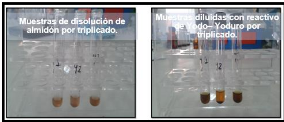
Ilustración 11. Determinación de almidón mediante prueba yodo realizada a las muestras diluidas.
