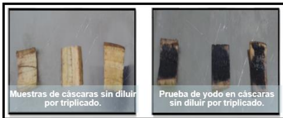
Ilustración 12. Determinación de almidón mediante prueba de Yodo realizada a muestras sin diluir.
