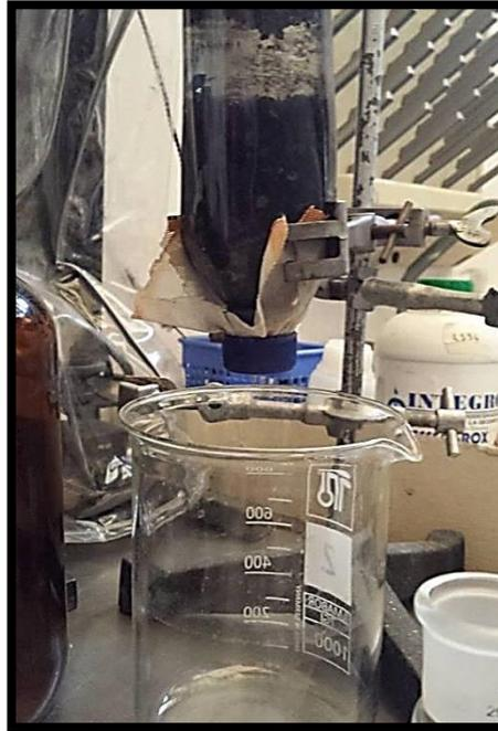
Al realizar el proceso de filtración del agua residual se obtiene un agua clarificada, sin sólidos, color u olor.
