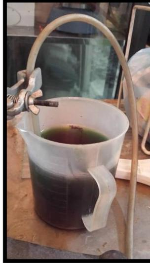
En la figura 25 se puede observar el procedimiento que se llevó a cabo para las pruebas de oxidación química realizadas para las muestras de agua procedentes del proceso de coagulación floculación.
