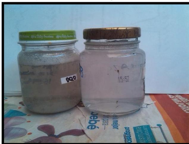
**Tabla 22.** Oxidación química con peróxido de hidrogeno por un tiempo de retención de 12 horas.
