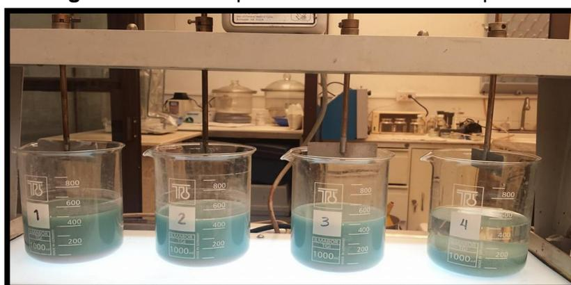
Como se puede observar en la figura 36, el agua residual de la jarra 4 en la cual se utilizó el rompedor inverso CHEMIFLOC-500 hay una remoción de color y materia orgánica suspendida y disuelta en el agua, mientras que en las demás jarras no hay efecto alguno por parte de los rompedores utilizados, ni siquiera una desestabilización de partículas en el agua residual.
