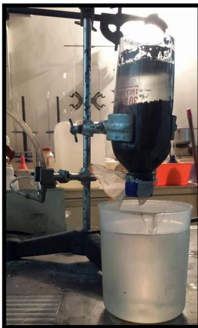
Después de obtener el agua aún más clarificada y con una remoción total de color, turbidez y olor, se procede a realizar la medición del parámetro crítico del agua residual industrial, es decir la DQO, obteniendo los siguientes resultados:
