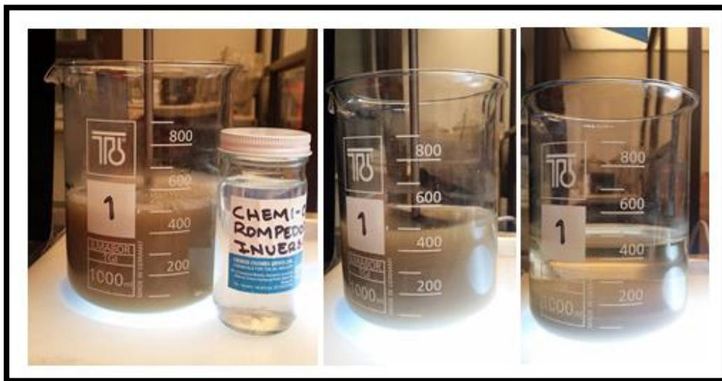
Después de obtener el agua totalmente clarificada, usando como coagulante-floculante el rompedor de emulsión inverso, se procede a realizar una filtración con carbón activado y arena para remover lo que queda de carga contaminante en el agua residual.
