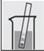
Comprobar el valor de pH de la muestra (**EXTRACCIÓN DE RESIDUOS**), Intervalo previsto: pH 1 - 8
