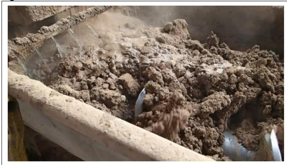
En este punto se homogenizo el lodo con la arcilla y se agregó agua mediante un sistema de aspersión, se observa en la tubería de PVC.
