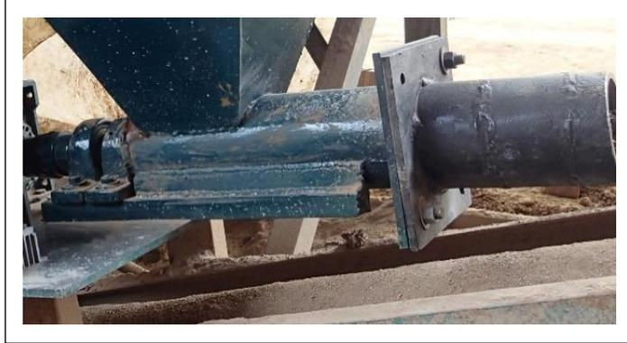
Aquí es a donde llega el lodo que está en la tolva, girando según la velocidad deseada, el lodo pasa a través de él y al final lo deposita en la banda transportadora que lleva la arcilla previamente molida.
