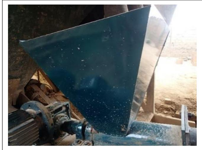
La estructura metálica fue pintada con pintura epóxica, para evitar que se deteriorara u oxidara la máquina.
