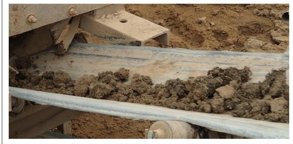
Por último se pasó al moldeado y corte, donde la mezcla es llevada por la cinta transportadora hasta el proceso de moldeado por compresión.
