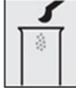
Introducir 2 **microesferas** raras de Cr-1 en un tubo de ensayo seco
