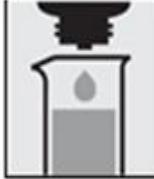
En caso necesario corregir el valor del pH añadiendo gota a gota solución diluida de hidróxido de sodio o ácido sulfúrico
