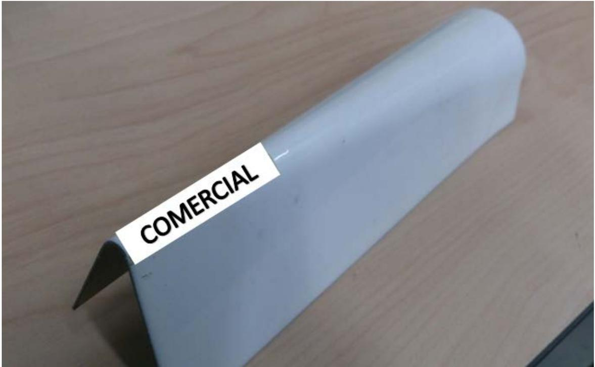
**3.4.4 Prueba de resistencia al impacto.** Se realizan impactos directos sobre el recubrimiento para una deformación cóncava o por el revés de la lámina para una deformación convexa. Este método ofrece resultados exclusivamente cualitativos.
