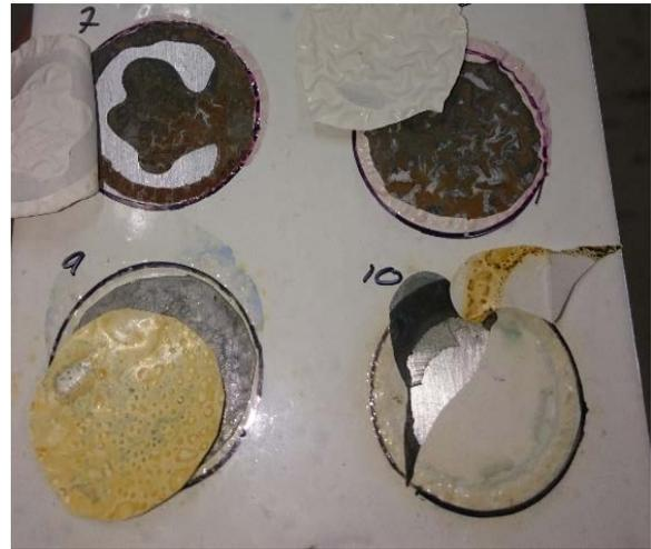
Figura 11. Resistencia química muestra comercial
