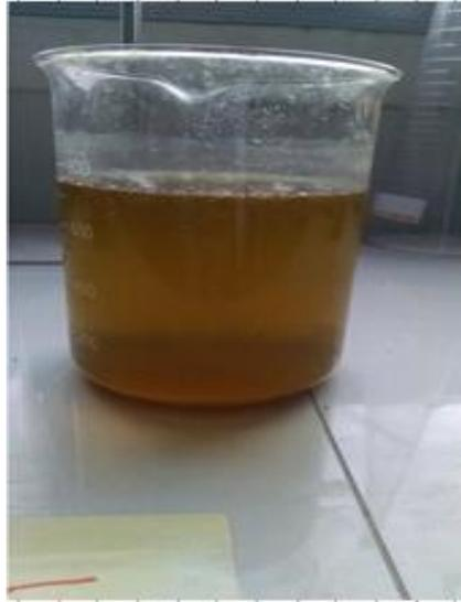
Se determinó el tiempo de reacción de 45 minutos porque pasado este tiempo la reacción no avanza, a 150 rpm en el equipo de jarras. Seguido de esto se tomó un tiempo de sedimentación aproximadamente de 30 minutos. Como objetivo principal de la pre-experimentación se determinó las condiciones de operación del método Fenton y se estableció los parámetros de operación mostrados en la **Figura 2**.
