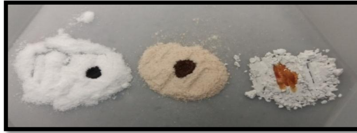
Figura 22. Coloración de yodo al contacto con almidón, polímero y carbonato de calcio.
