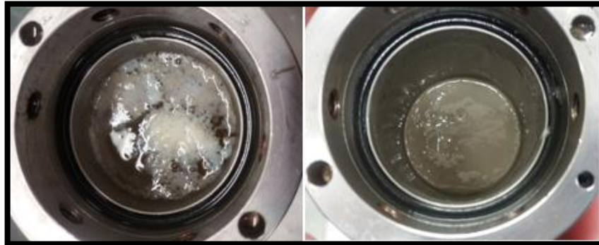
Figura 32. Limpieza de la celda retirando el breaker sobrante
