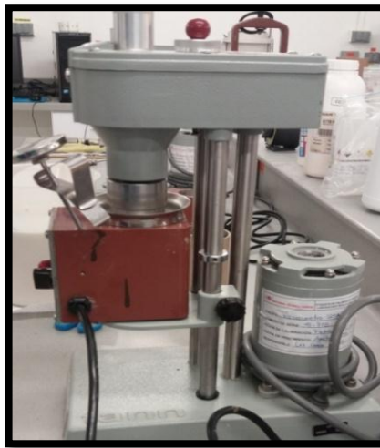
Figura 3. Viscosímetro Fann 35A
