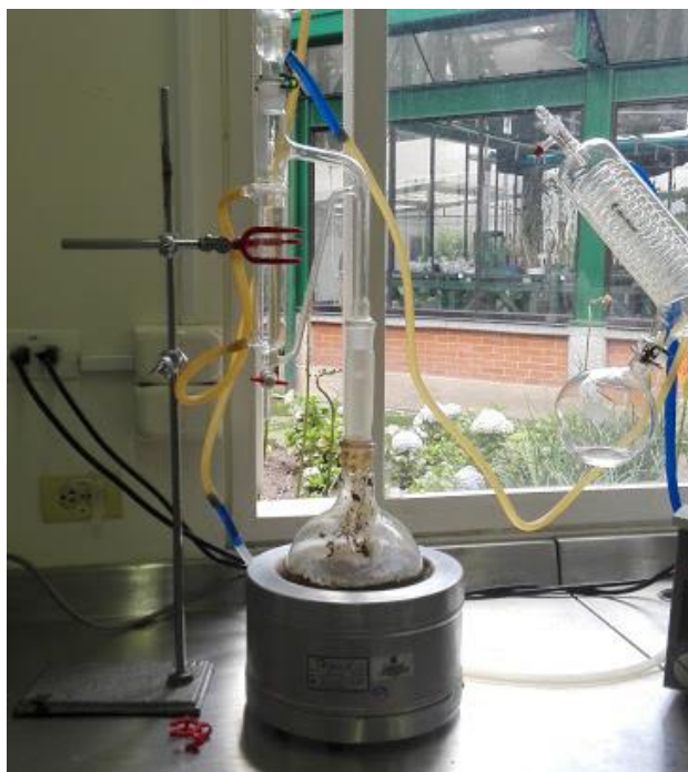
Foto 7. Montaje para la obtención de aceite esencial de Poleo ( Lippia turbinata Griseb).
