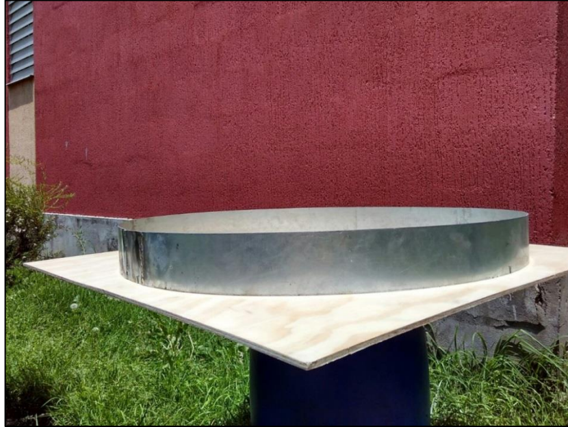
Foto 13. Soldadura de lámina galvanizada
