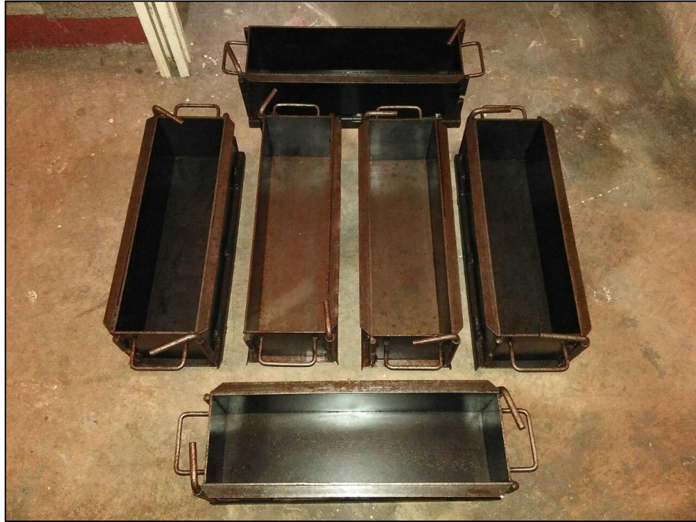
Foto 12. Moldes en forma viguetas 520 mm x 150 mm x 150 mm
