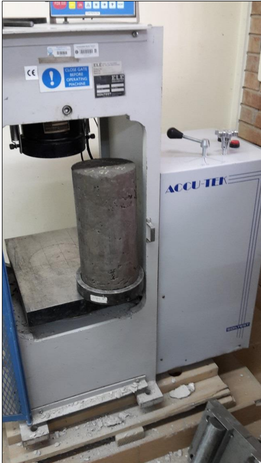
Foto 25. Máquina de compresión de cilindros y viguetas
