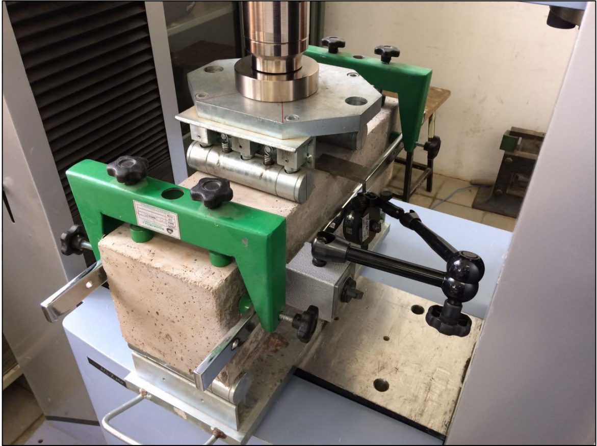
Foto 36. Falla de viguetas con deflectómetro
