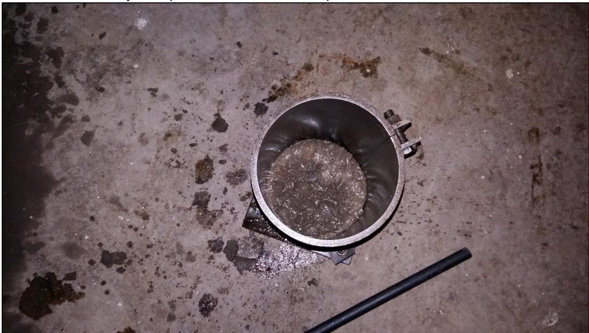
Foto 19. Llenado y compactado de cilindro al primer tercio
