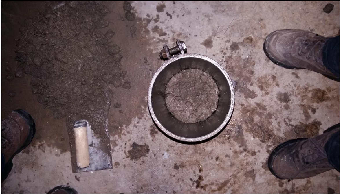
Foto 20. Llenado y compactado de cilindro con fibra al primer tercio
