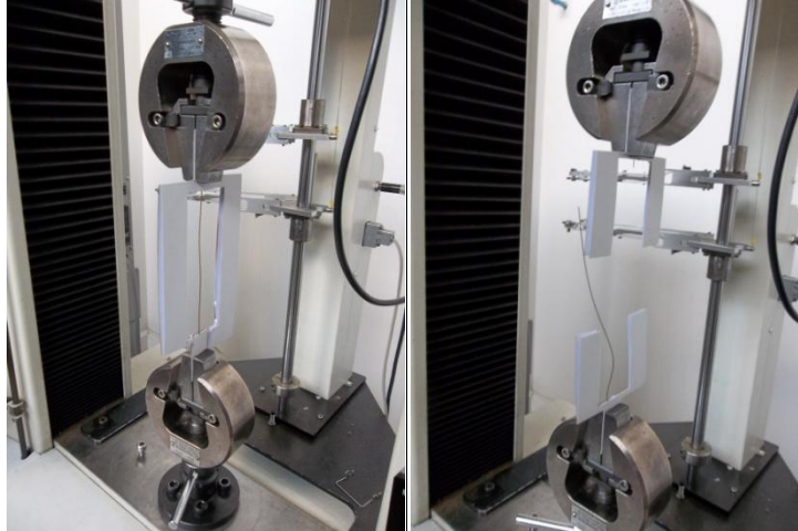
Figura 2. Fotografía de la izquierda: Instalación de la Probeta. Fotografía de la derecha: Probeta ensayada.
