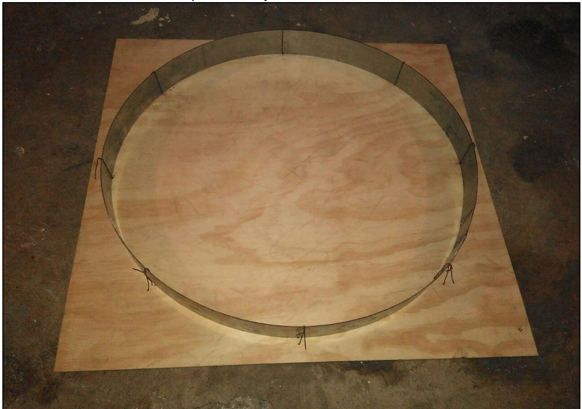
Foto 14. Molde terminado para ensayo de tenacidad a flexión 800 mm x 75 mm
