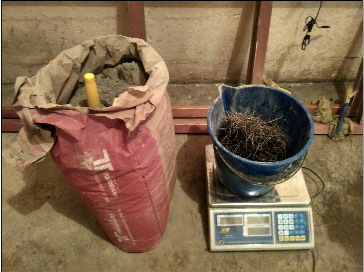
Foto 8. Cemento Tequendama tipo 1 y Polifibra de POLYALTEC S.A.
