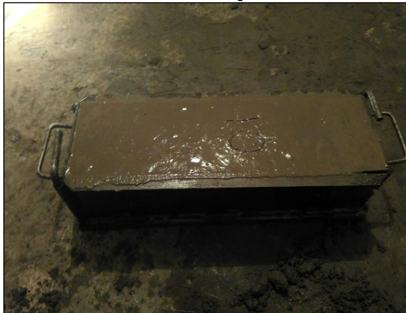
Foto 21. Llenado de molde de vigueta terminado
