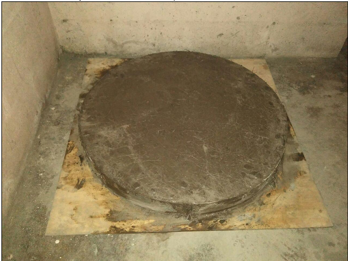
Foto 22. Vaciado y conformado final de panel redondo con 5% de fibra
