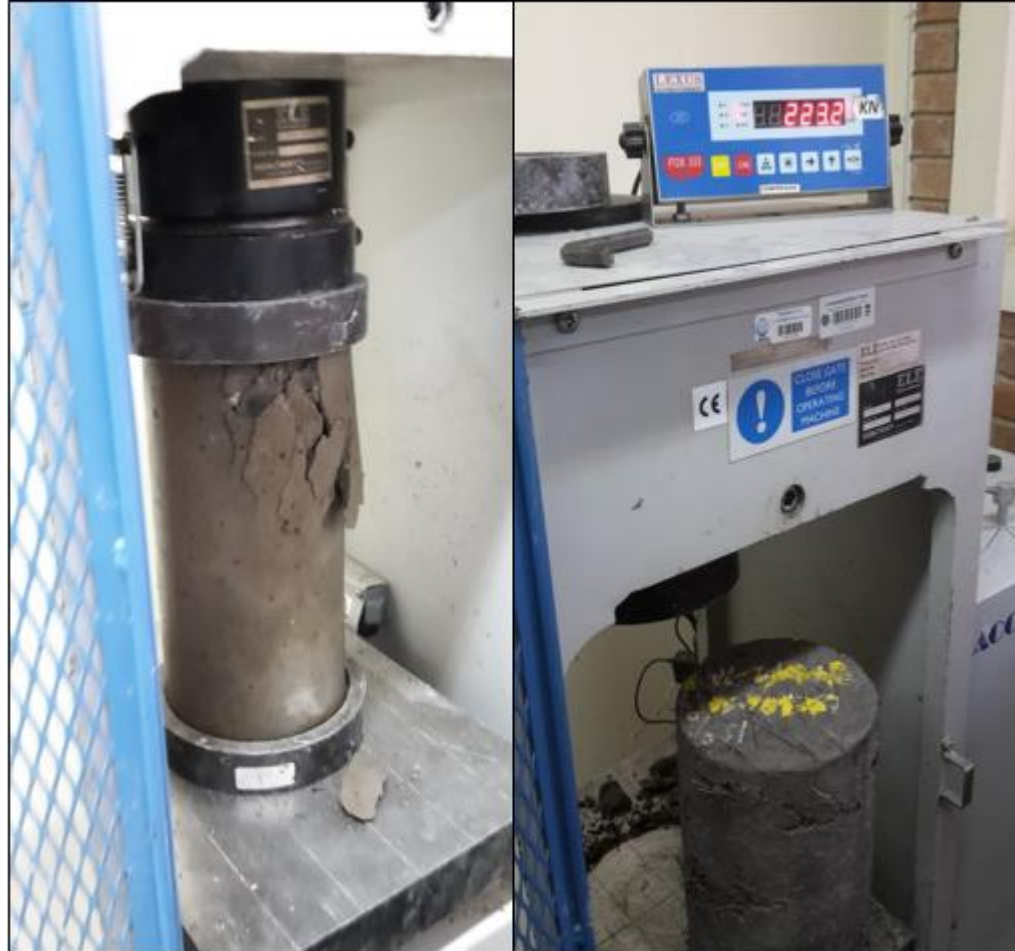
Foto 30. Comparación de cilindro sin reforzar vs reforzado con fibra
