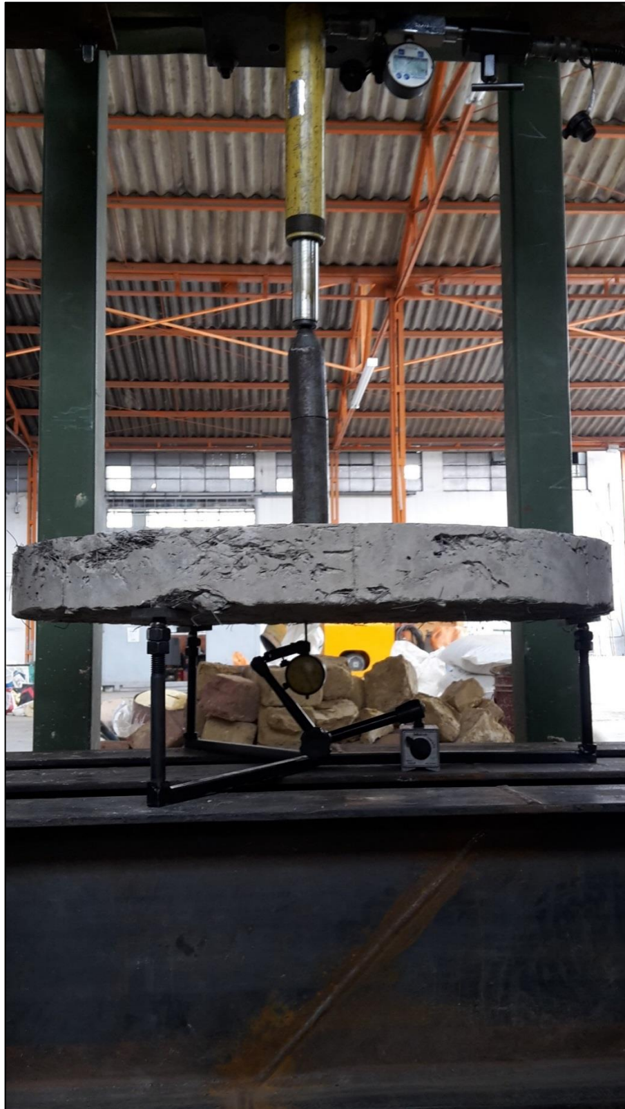
Foto 44. Montaje panel redondo para falla
