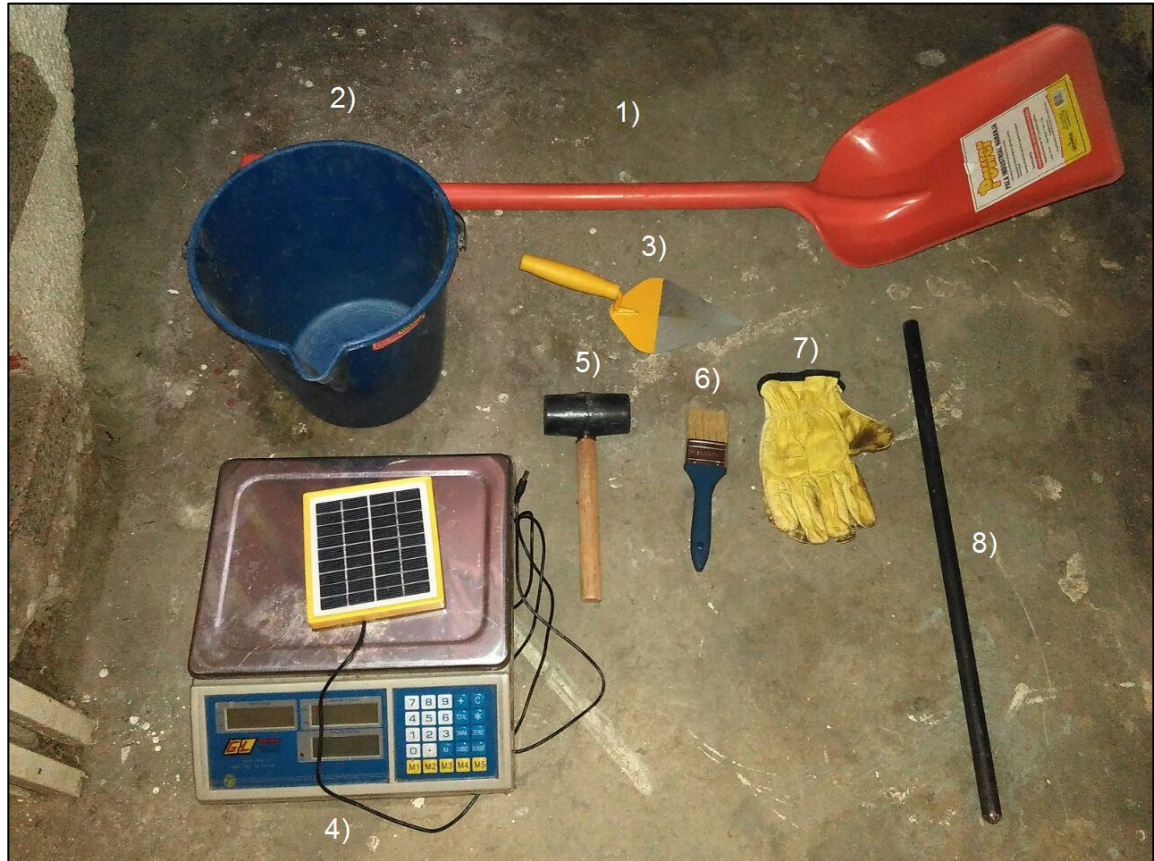
Foto 9. Elementos para fundida y curado de concreto
