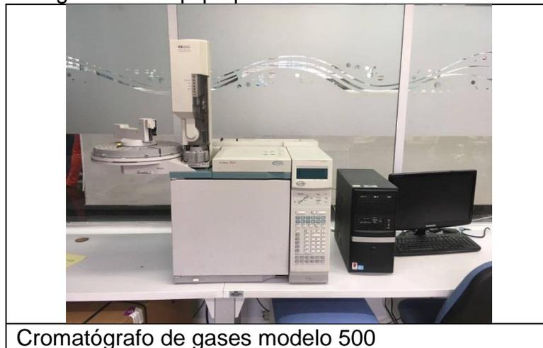
Cromatógrafo de gases modelo 500
