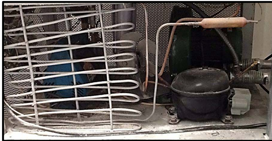
Figura 12. Condensador y compresor.
