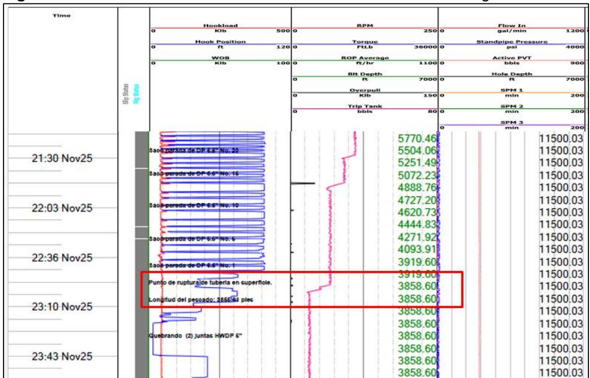
Figura 51. Evidencia de la desconexión de la sarta en el Incident Log del Pozo K.
