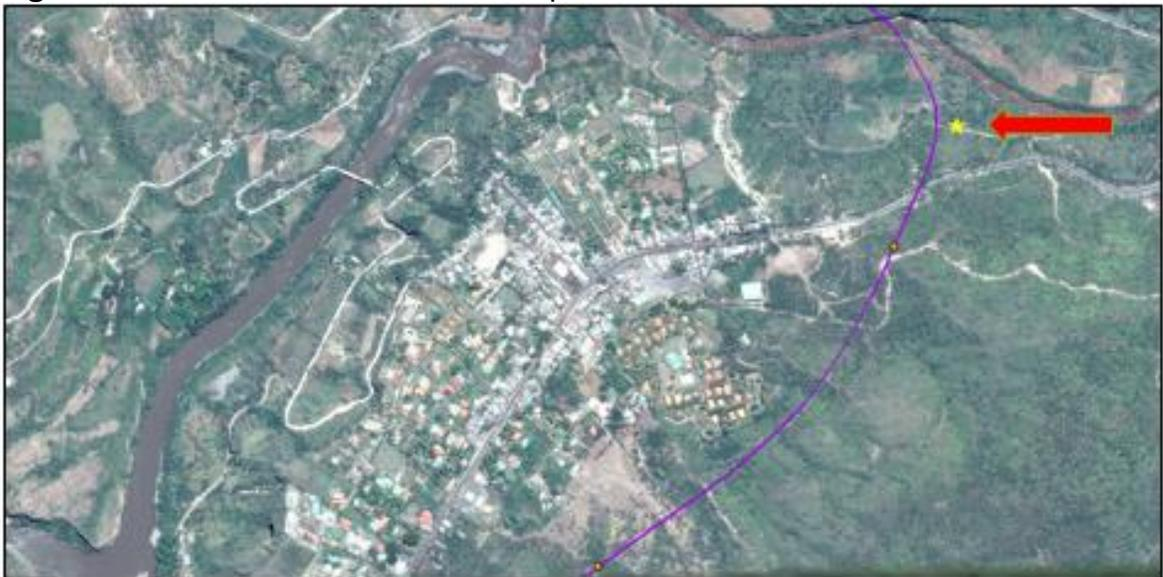
Se representa con color violeta el ducto, los puntos que se encuentran sobre el ducto son los puntos de control, que se observan a una vista más amplia con respecto a los puntos topográficos presentados en la **Figura 69**, explicados anteriormente y finalmente el nuevo punto de control, representado con una estrella, simboliza en el mapa la zona poblada (ver la flecha).
