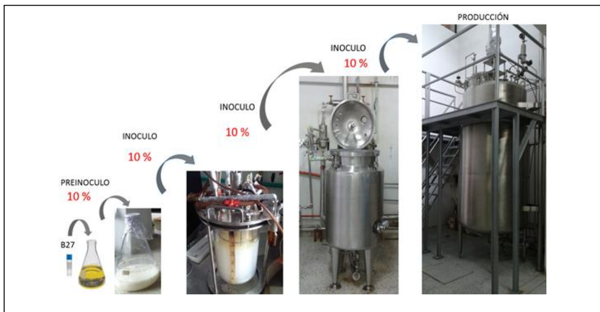
Figura 13. Protocolo de fermentación para el reactor de 2000 litros
