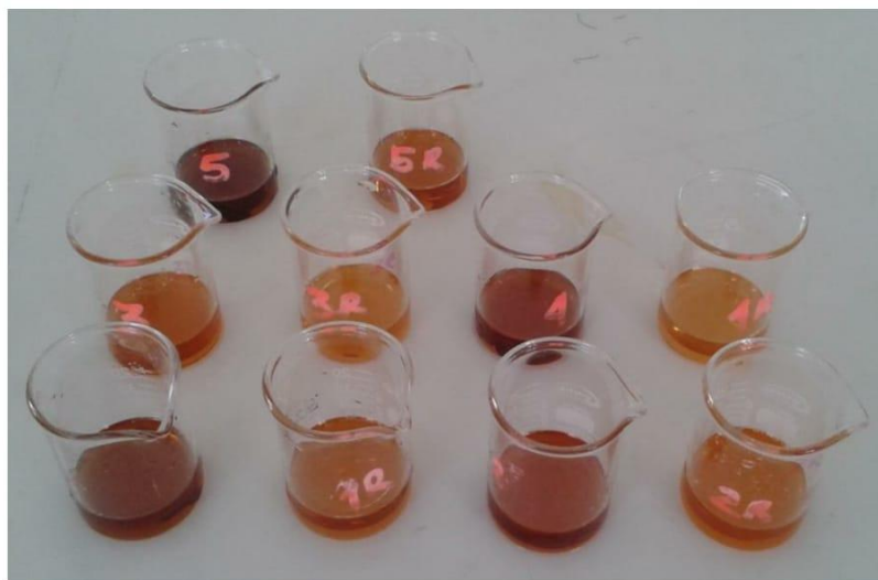
Ilustración 22. Muestras antes de dilución con ácido sulfúrico.
