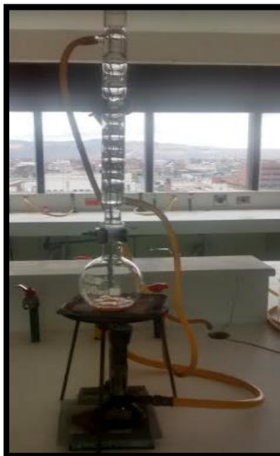
Ilustración 27. Montaje de calentamiento a reflujo.
