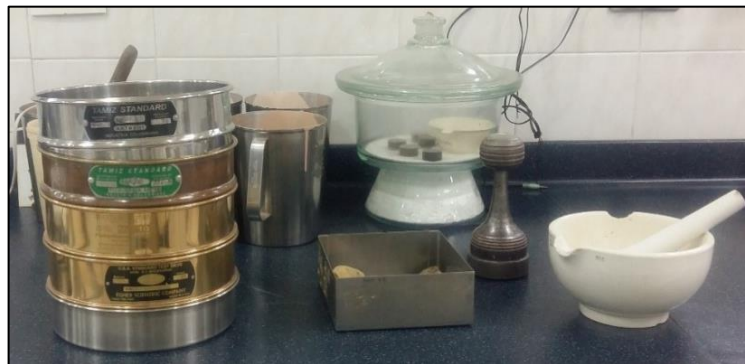
Figura 27. Montaje de tamices de mesh 6 – 10 – 12 – 60 – 80 – 100 – 200
