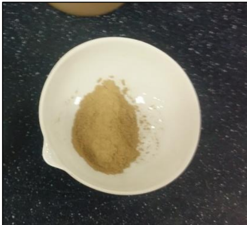
Figura 29. Partículas que pasaron por mesh 200, partículas traspasadas a capsula de porcelana para determinar su masa
