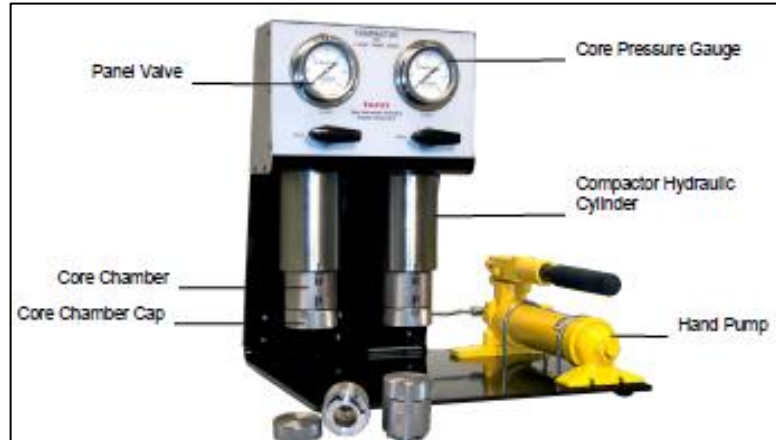
Figura 35. Compactador hidráulico de doble pistón
