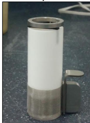
Figura 36. Malla y seguro del núcleo unidos en la base de ensamblaje
