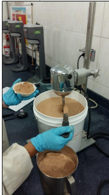
Figura 38. Preparación del fluido de perforación
