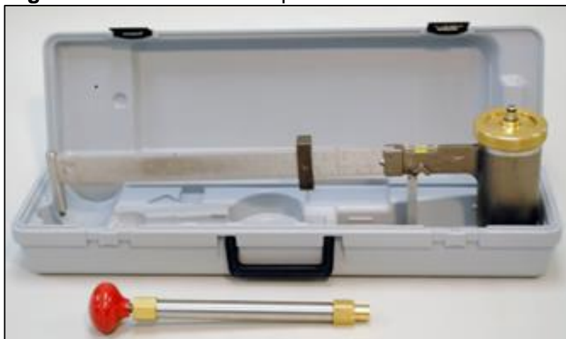
Figura 6. Balanza de lodo presurizada
