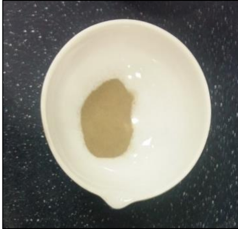
Figura 30. Partículas que pasaron por mesh 100, partículas traspasadas a capsula de porcelana para determinar su masa
