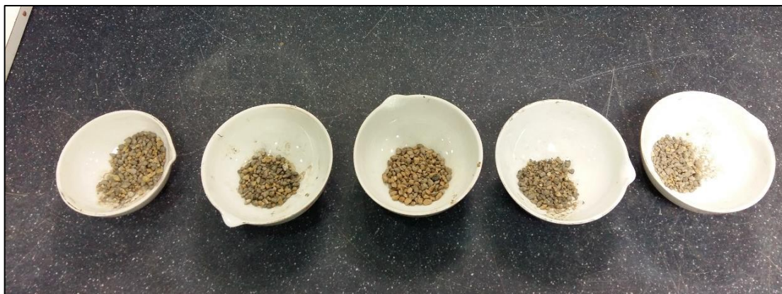
Figura 44. Muestras limpias y secas resultado de la prueba de dispersión y Erosión
