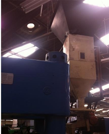
Imagen 15. Máquina inyectora Ottogalli 3, en donde se observa el husillo que arrastra el material hacia los moldes.
