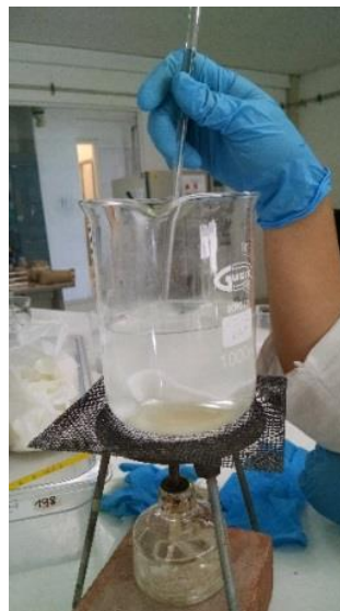
Figura 31. Proceso de impregnación del suavizante
