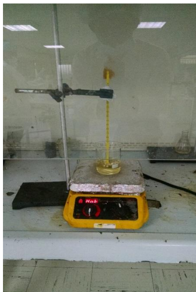
Figura 25. Formación del gel
